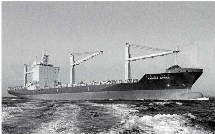
22 Knoten schneller 2122-TEU-Frachter mit drei 45-Tonnen-Kranen: „Maruba Africa“
